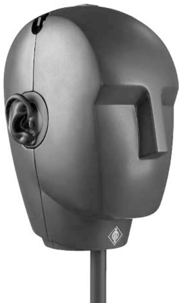
Fig. 31 Dummy Head (KU 100, Neumann)
